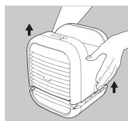
2. Нажмите кнопки блокировки с обоих сторон и медленно снимите крышку, чтобы успела стечь вся вода.
