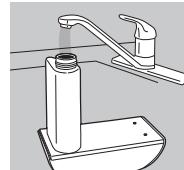
3. Fyld vandbeholderen med rent, koligt (ikke koldt) vand. Vi anbefaler, du bruger destilleret vand, hvis du bor i et område med hårdt vand. Du må aldrig tilføje vandet tilsætningsstoffer eller essentielle olier. Selv nogle få dråber vil beskadige enheden.
