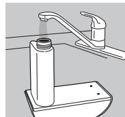
3. Vul de watertank met schoon, koel (niet koud) water. Wij adviseren gedistilleerd water te gebruiken als u in een gebied woont met hard water. **Gebruik nooit toevoegingen of etherische oliën in het water.** Zelfs een paar druppels zullen het apparaat beschadigen.
