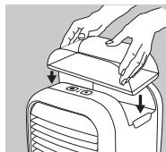
5. Anbring beholderen i MyChill åbningen og sørge for, at beholderen sidder godt fast. Vandet vil begynde at flyde over i vandkammeret.
