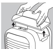
1. Отсоедините адаптер питания от сети электропитания и от прибора. Выньте бак для воды из верхней части корпуса прибора.
