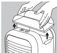
1. Scollegare l'Adattatore di corrente dalla presa a muro e dall'unità. Rimuovere il serbatoio dell'acqua dall'alloggio superiore.
