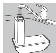
6. Une fois l'eau entièrement déversée dans la cuve, enlever le réservoir d'eau et remplir de nouveau en suivant les étapes 2 à 5 pour remplir entièrement le réservoir et la cuve d'eau.
