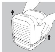
2. Drücken Sie die Freigabeb-Tasten auf beiden Seiten, nehmen Sie den Deckel vorsichtig ab und lassen Sie das gesamte Wasser abfließen.
