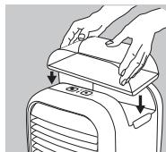
5. Coloque el tanque en la cavidad para ello diseñada en MyChill y asegúrese de que el tanque quede firmemente asentado. El agua empezará a llenar el depósito de agua.
