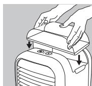
5. Placera tanken i hålrummet på din MyChill, och se till att tanken sitter fast ordentligt. Vatten kommer att börja överföras till vatten reservoaren.
