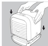
5. Substitua a Cobertura Superior no reservatório de água.
