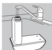
6. Заполните бак и резервуар водой, как указано в разделе «Заправка».
