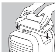
5. Setzen Sie den Tank in die Aussparung des MyChill und stellen Sie sicher, dass der Tank fest in dieser Aussparung sitzt. Das Wasser wird nun in den Wasserbehälter übertragen.
