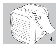
**Lagring av ditt personlige klimaanlegg:** Rengjør tanken og beholderen med en 50/50 blanding av eddik og vann. Tørk undersiden at det øvre dekselet med en myk, fuktig klut. Skyll kjølepatronen med vann
