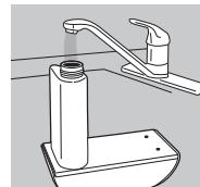
3. Füllen Sie den Wassertank mit sauberem, kühltem (nicht kaltem) Leitungswasser. Wir empfehlen die Verwendung von destilliertem Wasser, wenn Sie in einem Wohngebiet mit hartem Wasser wohnen. **Benutzen Sie keinen Zusatzstoff oder ätherische Öle für das Wasser. Schon wenige Tropfen beschädigen das Gerät.**
