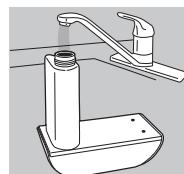
**6.** Assim que a água parar de passar para o depósito de água, retire o depósito de água e reencha seguindo os passos 2 a 5 para encher completamente o depósito de água e o reservatório.
