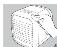
af Topdækslet af med en blød, fugtig klud. Skyld Afkølingspatronen med vand og lad den lufttørre. Skyld alle elementerne grundigt og lad dem tørre helt, før du pakker dem i den oprindelige emballage med henblik på opbevaring på et køligt, tørt sted.
