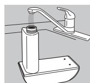
6. Suyun rezervuarına boşalması durduktan sonra, su deposunu çıkarın ve 2-5 adımlarını uygulayarak su deposunu ve rezervuarını tam olarak doldurun.
