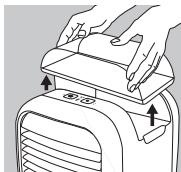
1. Desenchufe el adaptador de corriente de la toma de corriente de la pared y de la unidad. Extraiga el tanque de agua de la carcasa superior.
