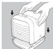
5. Remettre en place le couvercle supérieur sur la cuve d'eau.
