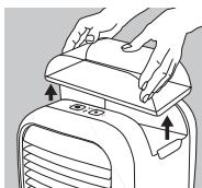
1. Odpojte napájací adaptér zo steny a z jednotky. Vyberte nádrž na vodu z vrchného krytu.
