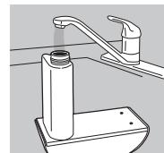
3. Fyll vattentanken med rent, svart (inte kallt) vatten. Vi rekommenderar att du använder destillerat vatten om du bor i områden med hårt vatten. **Använd aldrig några tillsatser eller essenser i vattnet. Bara ett par droppar kan skada enheten.**
