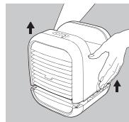
2. Pulse los botones de liberación a ambos lados y levante lentamente la cubierta superior, dando tiempo a que el agua se vacíe.
