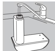
6. Når vandet ikke længere flyder over i vandkammeret, skal du fjerne vandbeholderen og fyld den op igen ved at følge trinene 2-5, så vandbeholderen og vandkammeret bliver helt fyldt.
