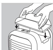
5. Zet de tank in de holte van de MyChill, en zorg ervoor dat de tank stevig op zijn plaats zit. Het water zal nu in het waterreservoir gaan lopen.
