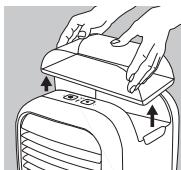
1. Trek de voedingsadapter uit het stopcontact en uit het apparaat. Neem de watertank uit de behuizing aan de bovenkant.
