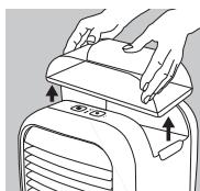
1. Odłączyć zasilacz od gniazdk i od urządzenia. Wyjąć zbiornik wodny z otworu na górze urządzenia.
