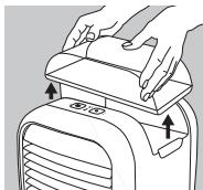
1. Débrancher l'adaptateur secteur de la prise murale et de l'appareil. Enlever le réservoir d'eau du logement supérieur.
