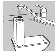
3. Riempire il serbatoio con acqua pulita fresca (non fredda). Raccomandiamo l'uso di acqua distillata in caso l'acqua della rete idrica sia dura. Non aggiungere mai additivi né oli essenziali all'acqua. Anche poche gocce danneggeranno l'unità.
