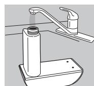
6. Kun vesi lakkaa tyhjentymästä veden siirtosäiliöön, irrota vesisäiliö ja täytä vaiheita 2–5 noudattamalla vesisäiliö ja siirtosäiliö uudestaan.
