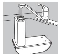
5. Установите бак в полость прибора MyChill так, чтобы он плотно встал на свое место. Вода начнет поступать в резервуар.
