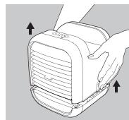
2. Druk de ontgrendelknoppen aan beide kanten in en til het bovenpaneel langzaam op zodat het water eruit kan lopen.
