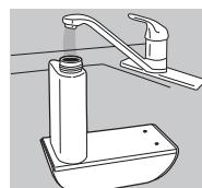
6. Una volta completato il travaso dell'acqua nella vaschetta, rimuovere il serbatoio e ripetere i passaggi da 2 a 5 per riempire completamente il serbatoio e la vaschetta dell'acqua.
