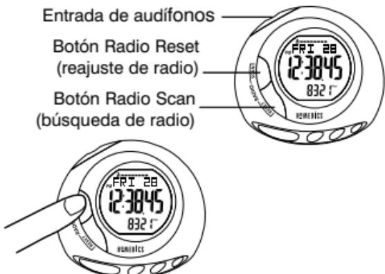
Para utilizar la radio FM, simplemente inserte el conector de los audífonos en el enchufe de entrada que se encuentra en el dispositivo. La estación de radio se visualizará automáticamente en pantalla señalando que la radio está encendida.
